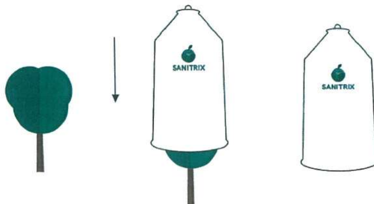
Img. 2 Breve illustrazione del processo di copertura della pianta con la Campana
